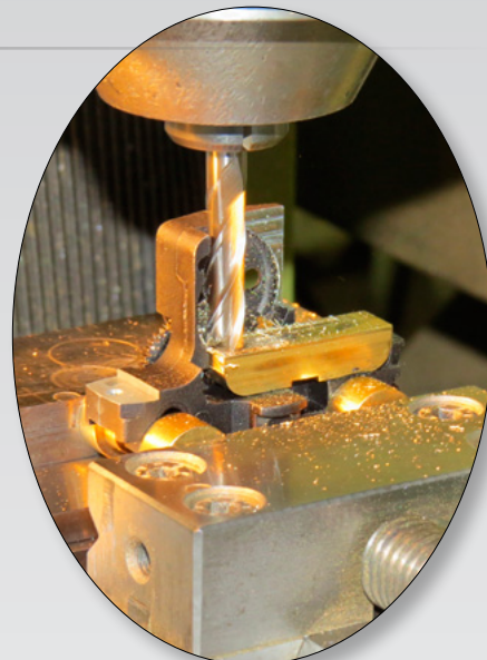
Fräsarbeiten an einem Märklin-Drehgestell. Foto: Manfred Merz
